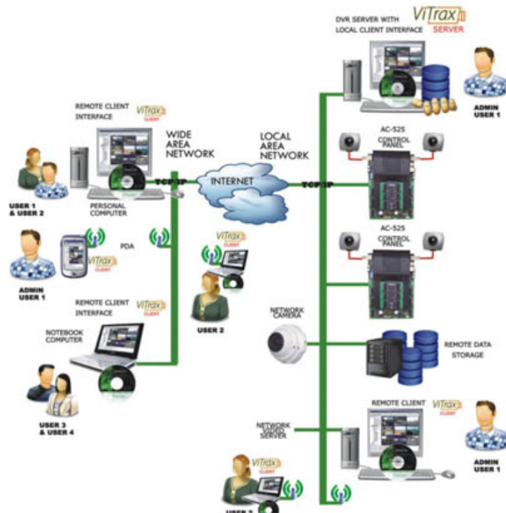
Arquitectura de una red típica del ViTrax™ AS-525AV Software profesional de vigilancia
